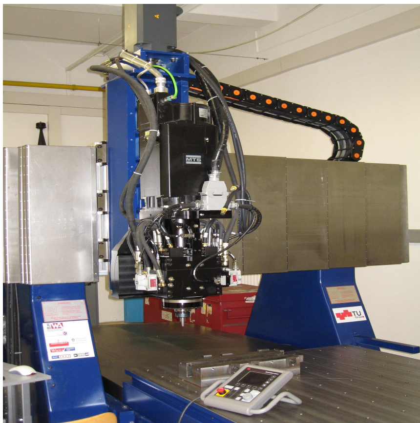
Obr. 9(a) Detail zariadenia na robotizované zváranie metódou FSW [16]
